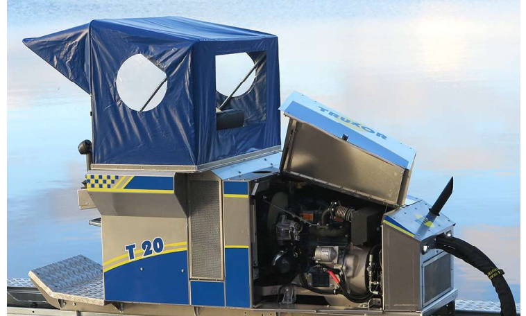
Легкодоступний моторний відсік полегшує обслуговування.
