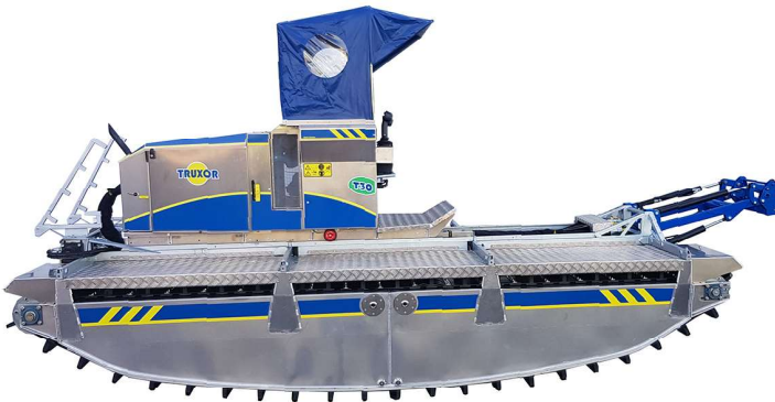
Рухома кабіна водія регулюється гідравлічно і працює як противага під час важкого перебування у воді.
