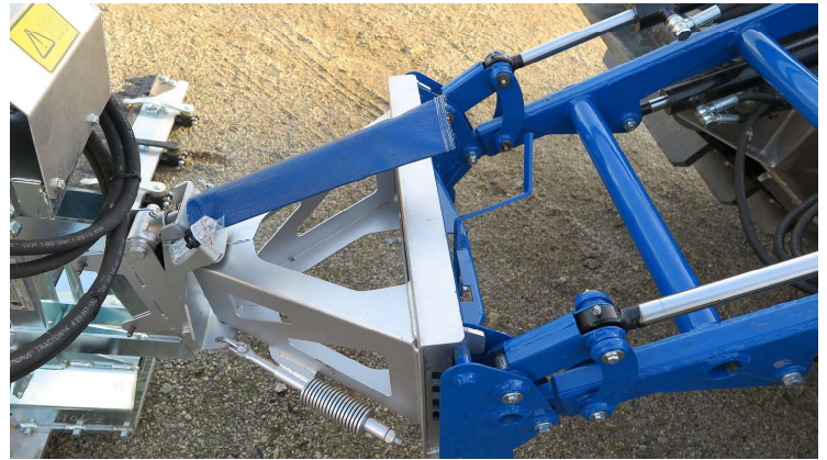
Рука лежачи з паралельним рухом. Напівавтоматичний швидкий кронштейн X4 для швидкої заміни інструменту.
