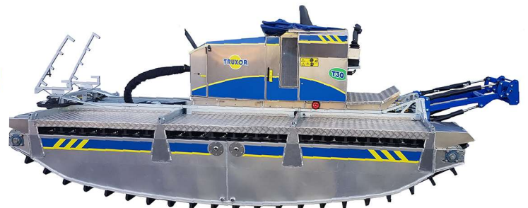
Рухома кабіна водія регулюється гідравлічно і працює як противага під час важкого перебування у воді.
